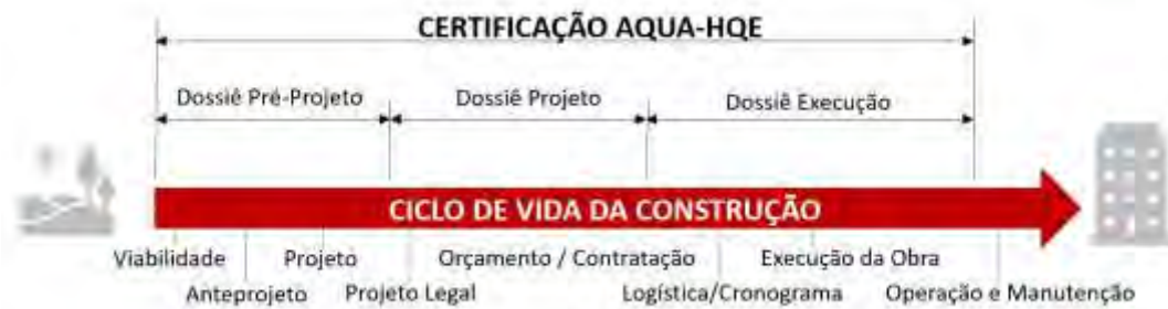
Figura 2: Ciclo de vida da construção AQUA-HQE
