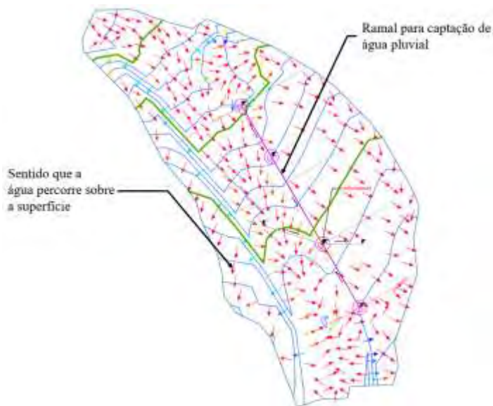
Figura 12: Escoamento superficial de águas de chuva
