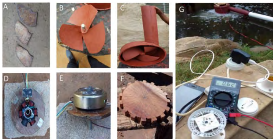
Figura 1: Construção e instalação do sistema. A: Molde das pás; B: rotor pintado; C: turbina pronta; D: estator com as bobinas; E: gerador finalizado; F: engrenagem de madeira; G: sistema instalado no rio.
