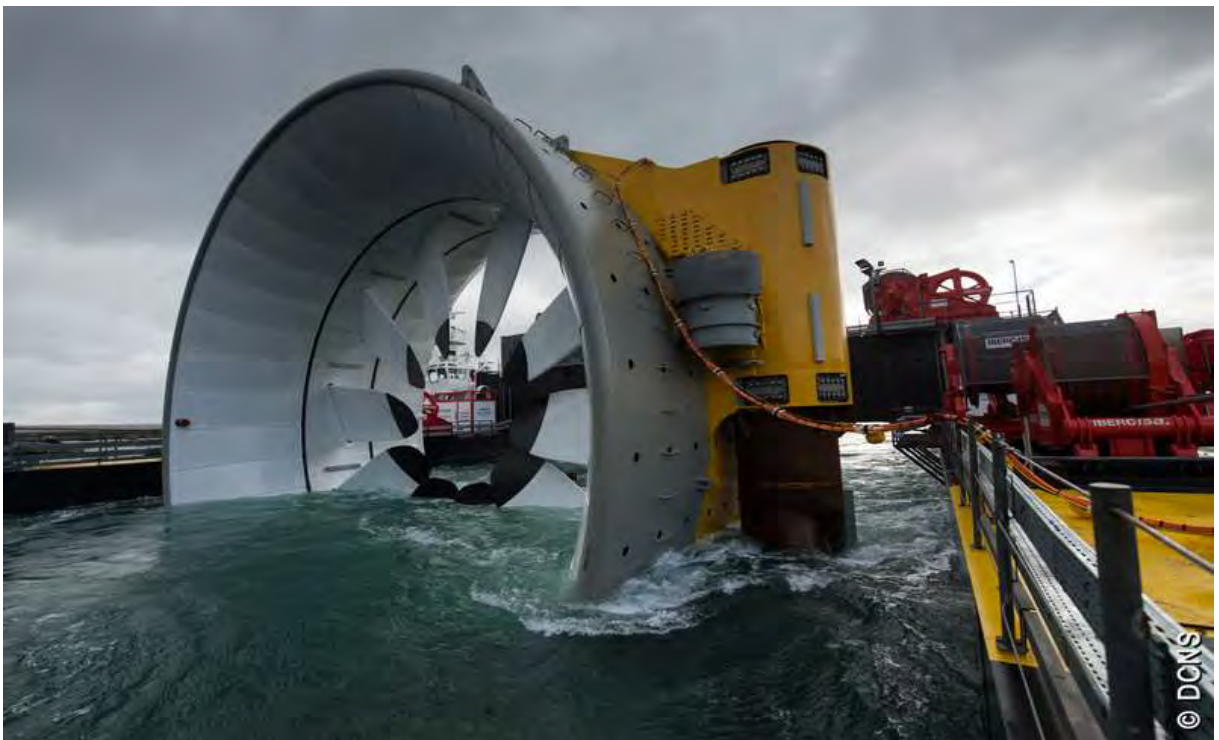
Figura 4 Exemplo de equipamento com regulagem vertical de geração de eletricidade a partir das correntes marinhas
