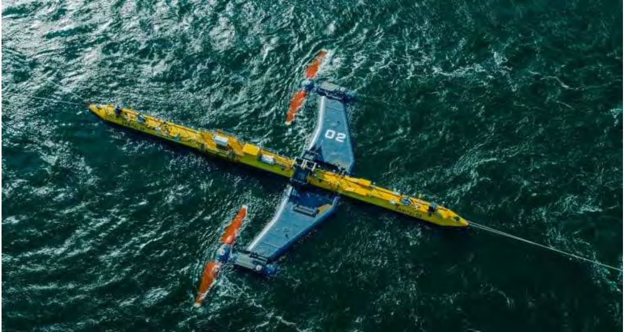
Figura 3 Exemplo de equipamento de geração de eletricidade a partir das correntes marinhas
