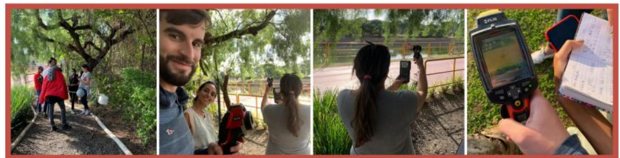
Figura 3: Medições no trabalho de campo, com uso da câmera e anemômetros. Fonte: Elaborado pelos autores.
