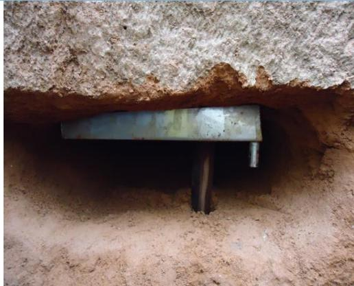
A) Visão da bandeja coletora sob a base inferior do lisímetro.
