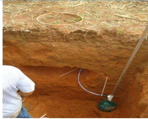
B) Bandeja sob lisímetro conectada ao frasco coletor (a 1,3 m) da água por mangueira e a um tubo de PVC que serve para retirada da água com bomba de vácuo.
