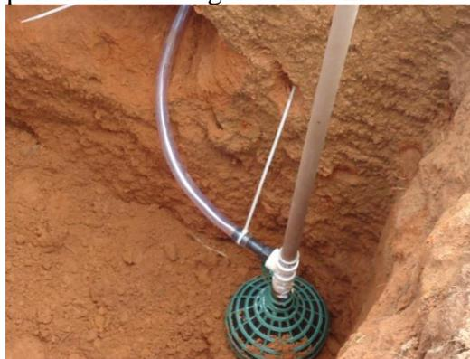
D) Visão do frasco coletor conectado à bandeja coletora da água do lisímetro.
