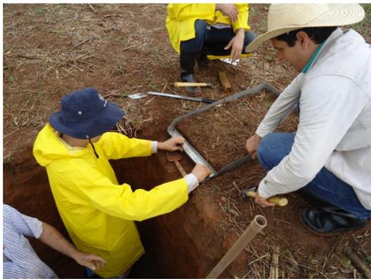
C) Instalação da calha coletora da água de escoamento.
