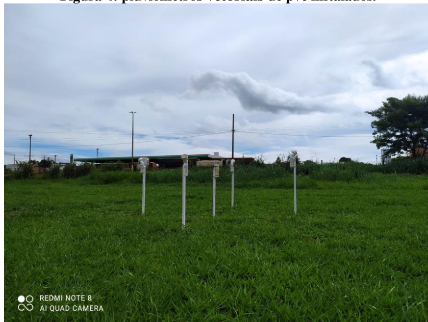
Figura 4: pluviômetros vetoriais de pvc instalados.
