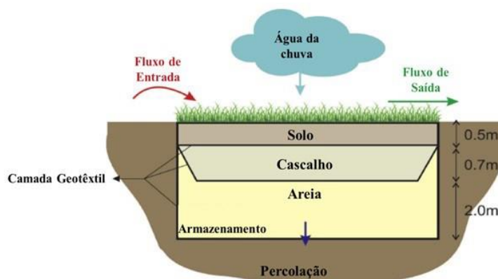
Figura 7. Representação esquemática de um sistema clássico de biorretenção. Fonte: (Davidovitsch et al. , 2023)
