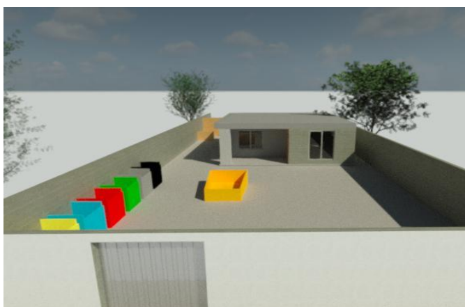
Figura 3: Organização do canteiro cenário 2 (PGRCC)- 6ª etapa da construção Fonte: Autores (2021)
