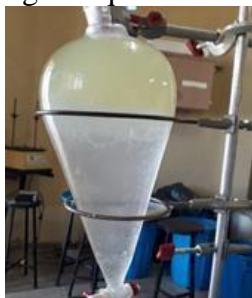
Figura 5: Lavagem aquosa do óleo residual.
