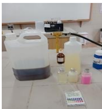
Figura 1: Óleo não purificado e óleo purificado (branqueado).
