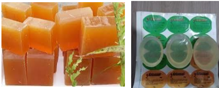
Figura 2: Base glicerínada não branqueada e base glicerínada branqueada.
