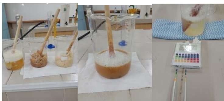
Figura 8: a) Massa base com óleo sem tratamento e com tratado. b) Base glicerizada sem tratamento. c) Base glicerizada com óleo residual tratado.
