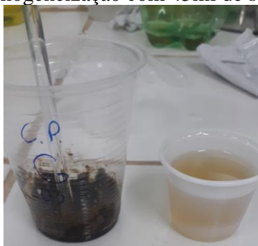
Figura 1 – Maceração e homogeneização com 45ml de solução saturada de sacarose.
